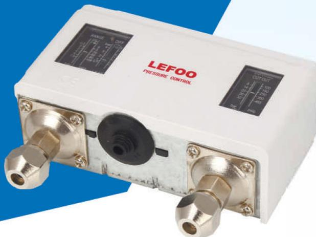
Сдвоенное реле давления LF58 предназначено для использования в холодильных установках и системах кондиционирования воздуха с целью защиты системы от слишком низкого давления всасывания или повышенного давления нагнетания. Реле давления успешно используется для управления и защиты водяных насосов, а также компрессоров в системах охлаждения.
