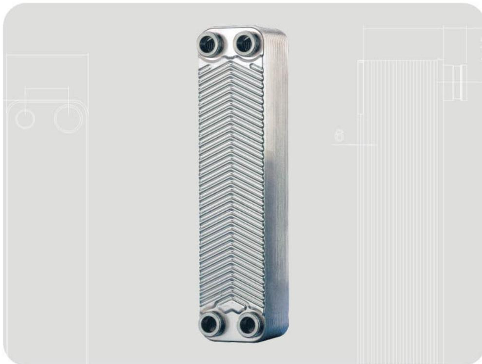
Уникальное и эффективное устройство E8T обеспечивает как экономические выгоды, так и преимущества в отношении охраны окружающей среды. Он разработан с целью максимальной утилизации топлива в котлах настенного монтажа, не образующих конденсата, и имеет функцию встроенного пуска и торцевые пластины, которые позволяют использовать для теплопередачи весь теплообменник. Конструктивное решение также сводит к минимуму выброс газов, опасных для окружающей среды.
