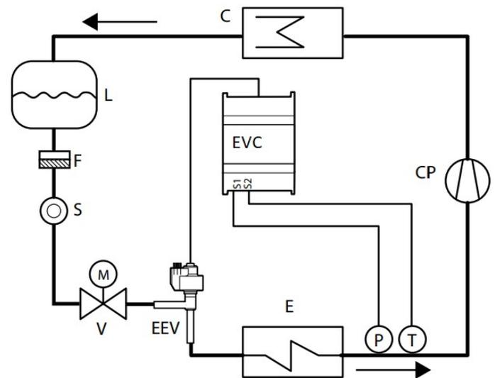
Рис 3.9 Схема ХМ с поддержанием перегрева в испарителе
