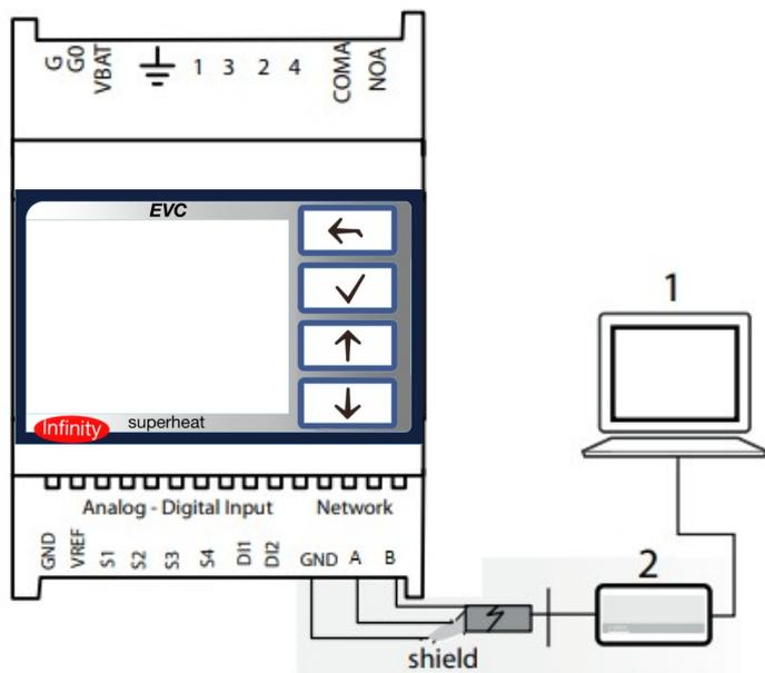
Рис 2.5 1 — ПК, 2 — преобразователь USB – RS485.
