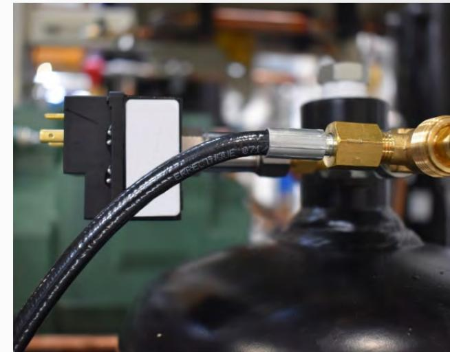
TUBO TERMOPLASTICO CON TRECCIA DI RINFORZO TESSILE, SERIE 071-CO2, CLASSE 1 - EN 1736 E ISO 13971 PER REFRIGERANTI NATURALI
