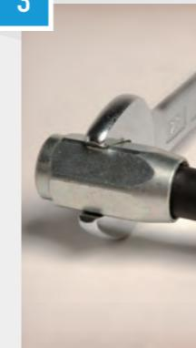
Impugnare il tubo e avvitare il manicotto in senso antiorario con apposita chiave sino a portare il tubo a circa 2-3 mm dalla battuta interna.
