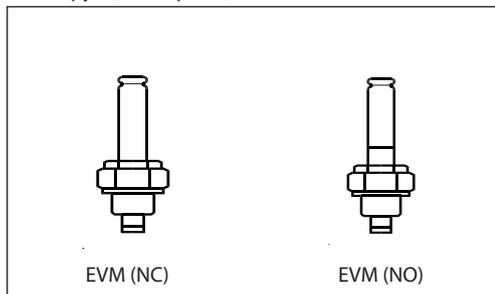
Клапаны EVM – это соленоидные пилотные клапаны, которые используются с клапанами ICS или PM, когда необходимо обеспечить их работу в режиме открыт/закрыт. Клапаны EVM работают с катушками для соленоидов производства компании Данфосс («Катушки для соленоидных клапанов», техническое описание RD3JB).
