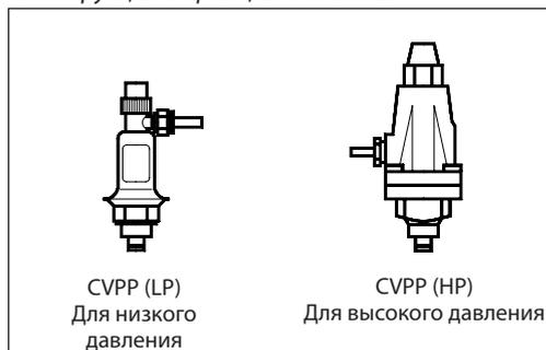
Пилотные клапаны разности давлений CVPP выпускаются в двух модификациях: для работы при низком и высоком давлениях.
