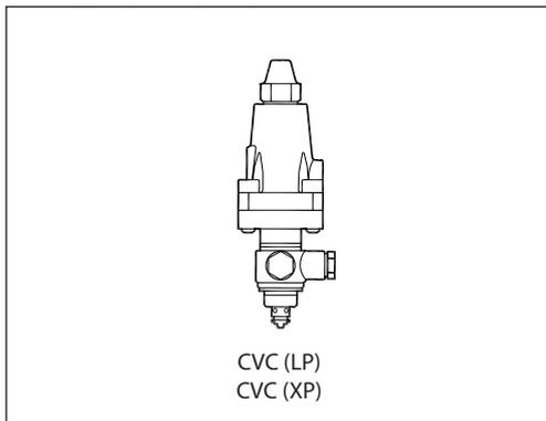
Пилотные клапаны CVC — это управляемые давлением пилоты со штуцером, по которому может подаваться давление из системы (опорное давление).
