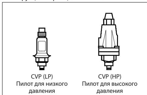
Пилотные клапаны постоянного давления CVP выпускаются в двух модификациях: для работы при низком и высоком давлениях.
