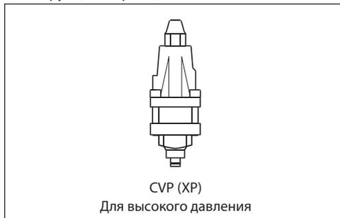
Пилотные клапаны постоянного давления CVP (XP) предназначены для работы при высоком давлении. Они поддерживают эффективный непрерывный процесс оттаивания горячим газом в системах с CO<sub>2</sub>.
