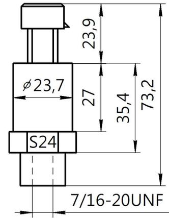
LFT2000 – керамический датчик давления для систем автоматизации с компенсацией температуры окружающей среды. Датчики выпускаются с различным типами выходных сигналов, резьбы для присоединения к процессу, а также с различными диапазонами измеряемого давления.
