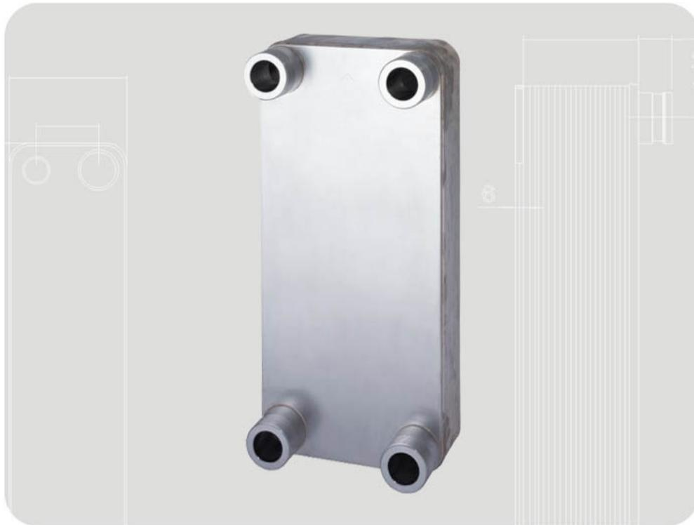
Устройство P120T - это новый испаритель, оптимизированный под достижение более высоких рабочих характеристик при использовании хладагента R410A. Этот высокоэффективный теплообменник сочетает в себе оптимальный размер и специально разработанный рельеф пластин с уникальной тепловой длиной. P120T представляет собой естественное решение для многих охладителей, тепловых насосов и экономайзеров.
